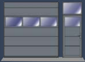
Opgelijnd met overheadpoort met beglaasde sectie
